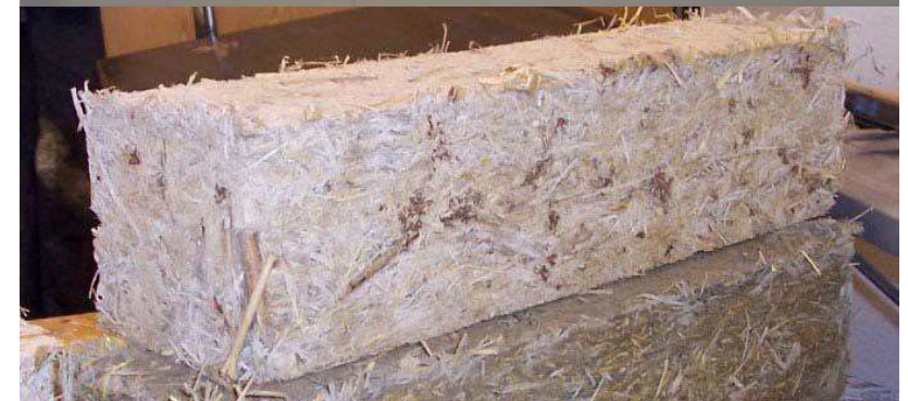
Kuva: Kipsi- ja sementtiruokoharkot. Tatu Toivosen opinnäytetyö, Turun AMK: Ruokoharkko rakentamisessa.
