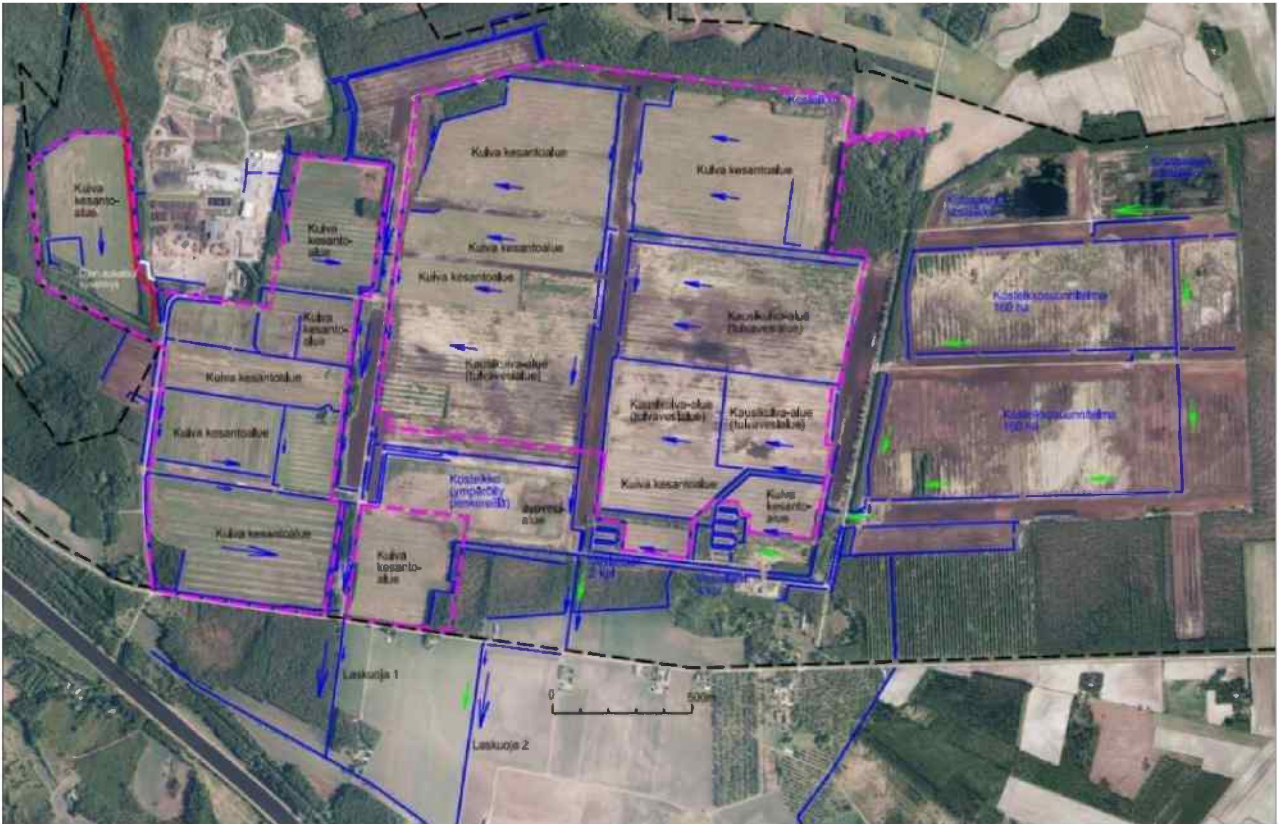
Kuva 13. Vesien johtaminen entisellä turvetuotantoalueella. Alueen vedet on johdettu kolmen laskujan kautta Soskuarjokeen. (Forus 2023a)
