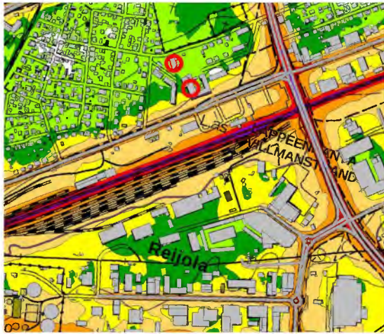
Kuva 26 Yläkuvassa päiväajan keskiäänitasot nykytilanteessa vuonna 2021 ja alakuvassa päiväajan keskiäänitasot ennustetilanteessa vuonna 2040 (WSP 2021). Punaisilla ympyröillä on merkitty melulle herkät kohteet eli päiväkodit, koulut ja hoitolaitokset
