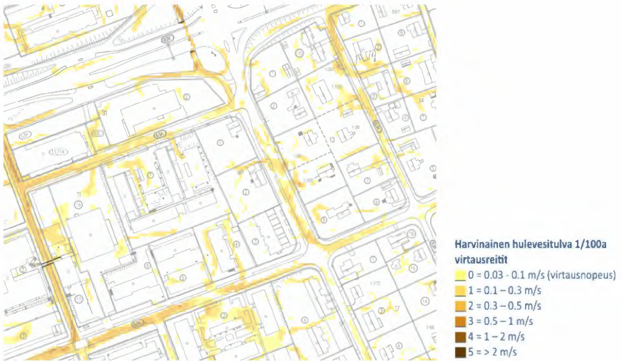
Kuva 14. Tulvakartta kuvaa harvinaisen hulevesitulvan virtausreitit. (kuva: Trimble Locus Cloud).
