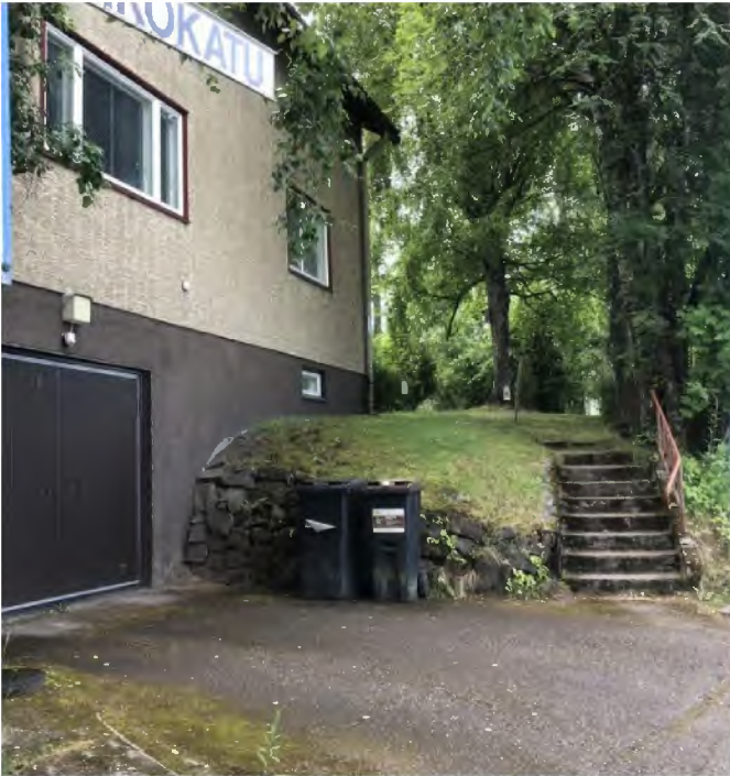
Kuva 8. Kuvassa näkyy rakennuksen liittymistä maastoon, ja siitä voi huomata, kuinka jyrkästi maasto nousee kadulta tontille. Rakennuksen sisäänkäynneille ei ole esteetöntä kulkua, sillä ainoa vaihtoehto sisäänkäynneille on jyrkkien portaiden kautta. Tontilla ei ole erillistä jätekatosta, vaan jäteastiat ovat esillä lähellä katua.
