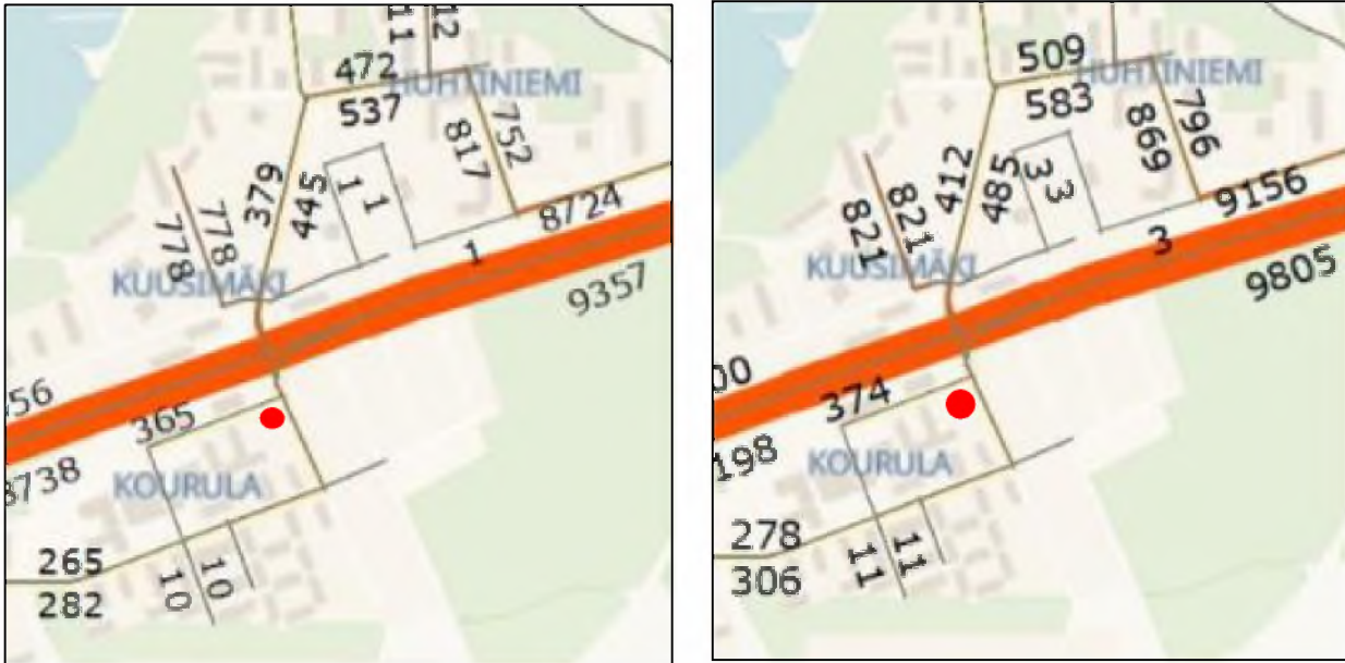
Kuva 17. Vasemman puoleisessa kuvassa esitetty vuoden 2020 liikennemäärät (ajoa/vuorokausi) suunnittelualan ympäristössä. Oikeanpuoleisessa kuvassa esitetty vuoden 2040 liikennemäärät (ajoa/vuorokausi) suunnittelualan ympäristössä. Suunnittelualue on merkitty kuviin punaisella ympärillä. Kuvat: Lappeenrannan liikenne-ennuste WSP Finland Oy 2021
